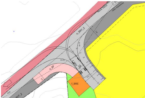
Figur 12: Svingradie og løsning for renovasjonsbil
